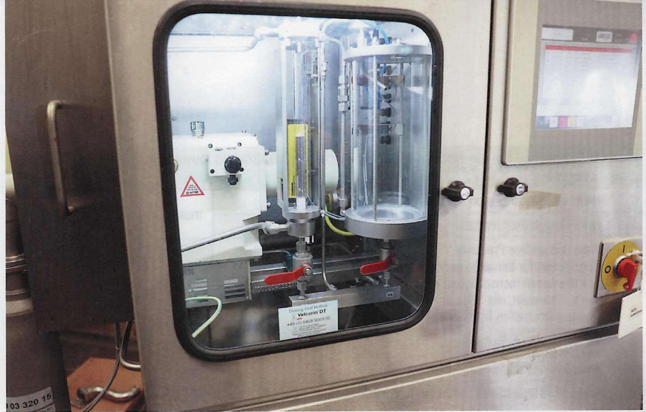
DMDC darf nur von geschultem Personal über eine Dosiereinrichtung (Bild) während der Abfüllung zugesetzt werden.
